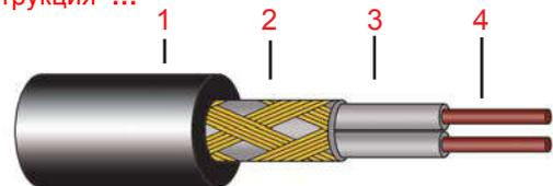
Двужильный экранированный нагревательный кабель с двойным покрытием и с внешней оболочкой UV-Protektion (стойкая к ультрафиолетовым лучам).
